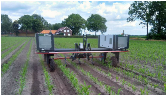
figuur 4 Robotisering kan wiellast helpen te beperken (Vwww.wur.nl/nl/show/robotti.htm)
