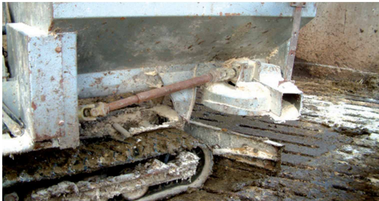
Via een aftakasoverbrenging wordt de strooischijs aangedreven. De strooihoek is instelbaar.
