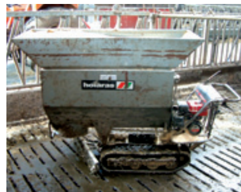
De bak is ver naar voren geplaatst wat minder is voor de stabiliteit. De rupsen geven echter wel veel zijdelingse stabiliteit, een grote wendbaarheid en veel tractie.
