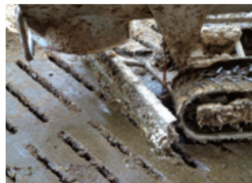
Het zicht op het schuifje is beperkt. Wel is hij zeer functioneel en is met een hendel te heffen.
