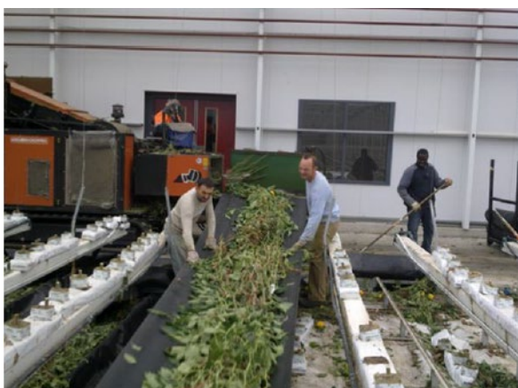
Figuur 4 Versnipperen van gewasresten in de glastuinbouw [14]
