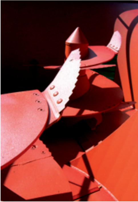
In de mengbak van de 1200 Double staan twee verticale vijzels.
