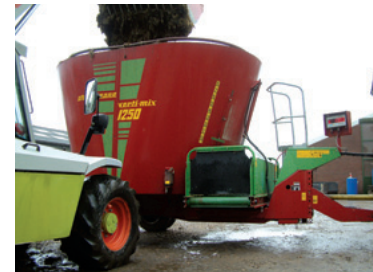
De Verti-Mix 1200 Double mengt het voer met zijn twee vijzels homogener dan de Verti-Mix 1250 van Strautmann.
