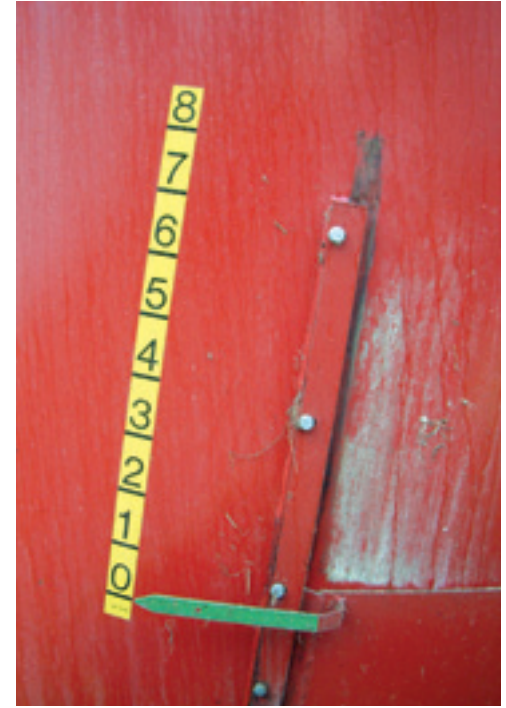
Een duidelijke wijzer geeft aan hoe ver de losschuif open staat.
