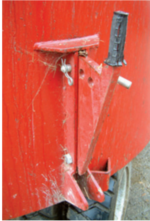
De met de hand bediende tegenmesses laten zich moeilijk in en uit bewegen.
