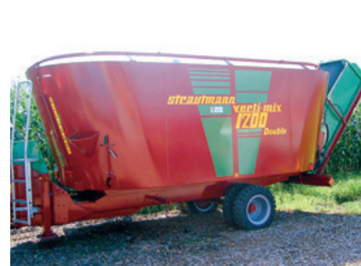
De Verti-Mix 1200 Double mengt het voer met zijn twee vijzels homogener dan de Verti-Mix 1250 van Strautmann.
