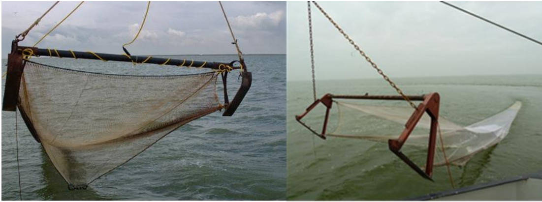
Figuur 4.1 Vistuigen in de openwatermonitoring: elektrostramienkor (links) en verhoogde 4-meter boomkor (rechts). Foto's: E. van Os-Koomen.
