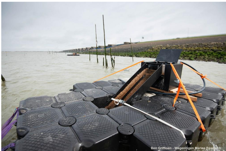
Figuur 6.3 Aanzicht van een glasaaldetector ('elver finder', ELFI). Foto: B. Griffioen.
