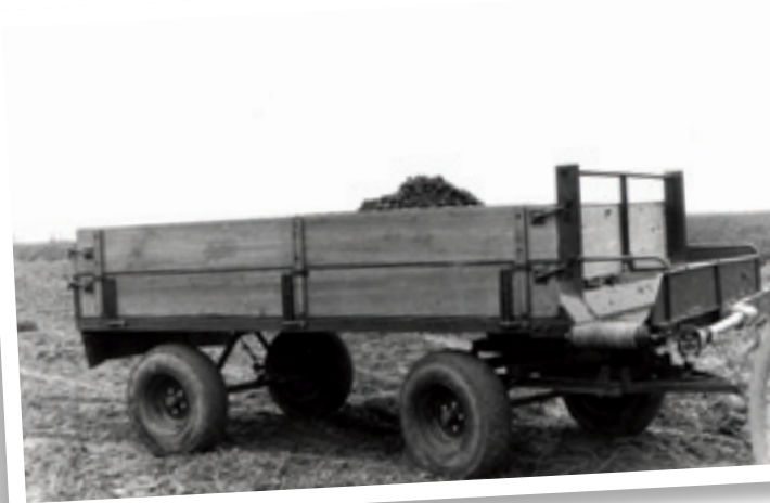
De eerste Miedema 'kipper' vol met aardappelen: een vierwielige loswagen met oproldoek en dwarsafvoerband.
