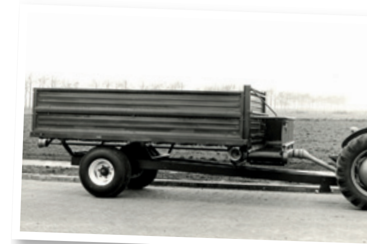
Om te velde ook te kunnen overladen heeft de loswagen van Schuitemaker een extra koppeling voor de aandrijving van een transporteur via een aftaktussenas. De dwarsafvoerband is afneembaar en ook kan achterop geplaatst worden.
