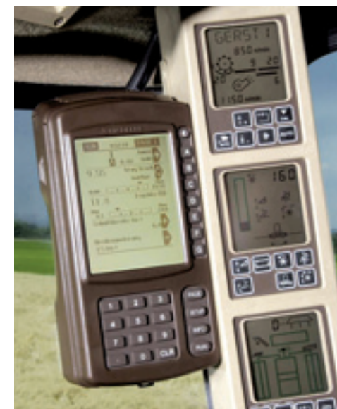
Met het 'automatische management-systeem' in de maaidorsercabine zijn de afstellingen instelbaar en wordt de machine compleet bewaakt.
