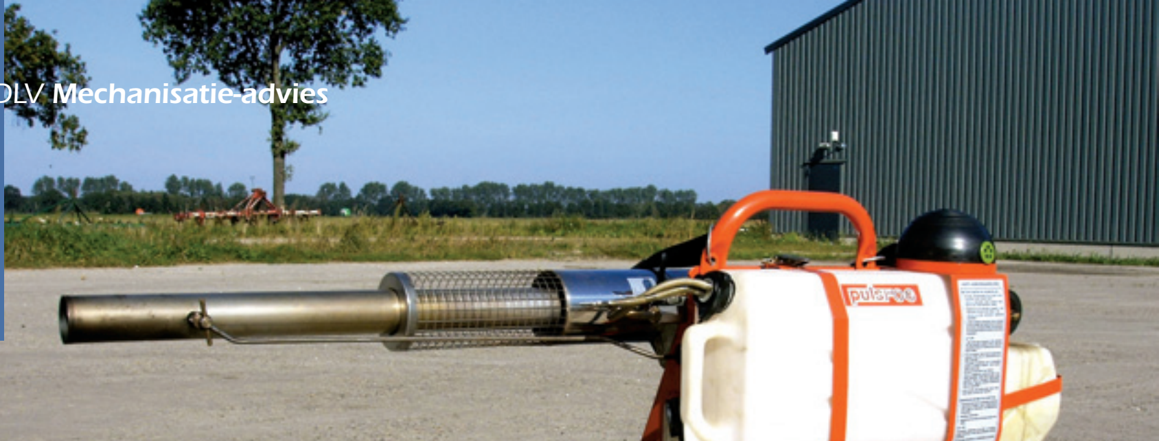
Pulsfog gasapparaat, voor het toedienen van vloeibare kiemremmingmiddelen tijdens het bewaarzeizoen.
