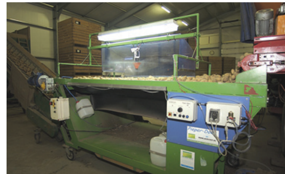
De Pieper-Does kan worden geleverd op een rollertafel van verschillende werkbreedtes, voorzien van een transparante slagvaste nevelkap met retourvanggoten. Het systeem kan op elke situatie worden aangepast.
