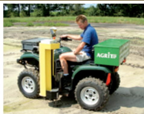
Plaatsspecifiek grondmonsters nemen kan met een minigrondboor op een quad. Elke prik vraagt maar enkele seconden. Alle prikken worden genomen in een straal van 20 m. Resultaat: diverse bodemkaarten van bijvoorbeeld pH, organische stof, fosfaat- en kaligehalte.
