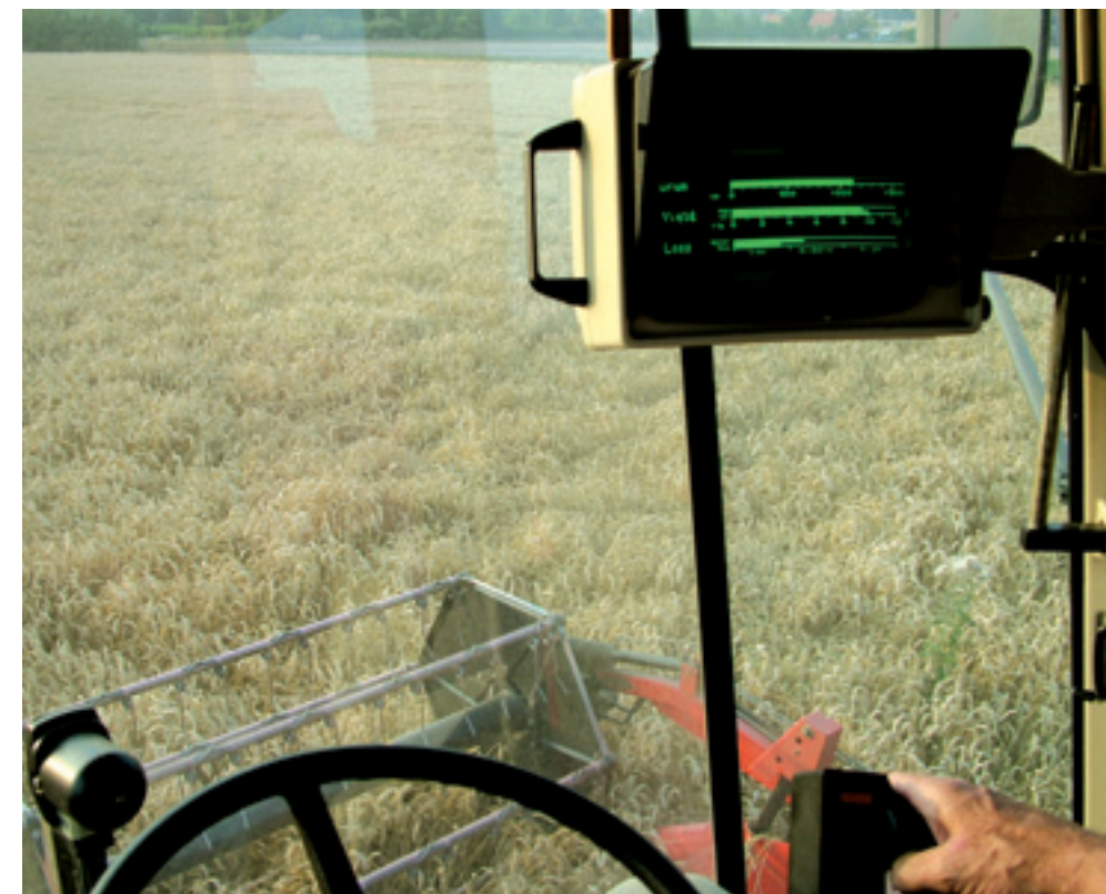
Tijdens het dorsen kun je op deze maaidorser met GPS zend- en ontvangerapparaat direct de opbrengst zien.
