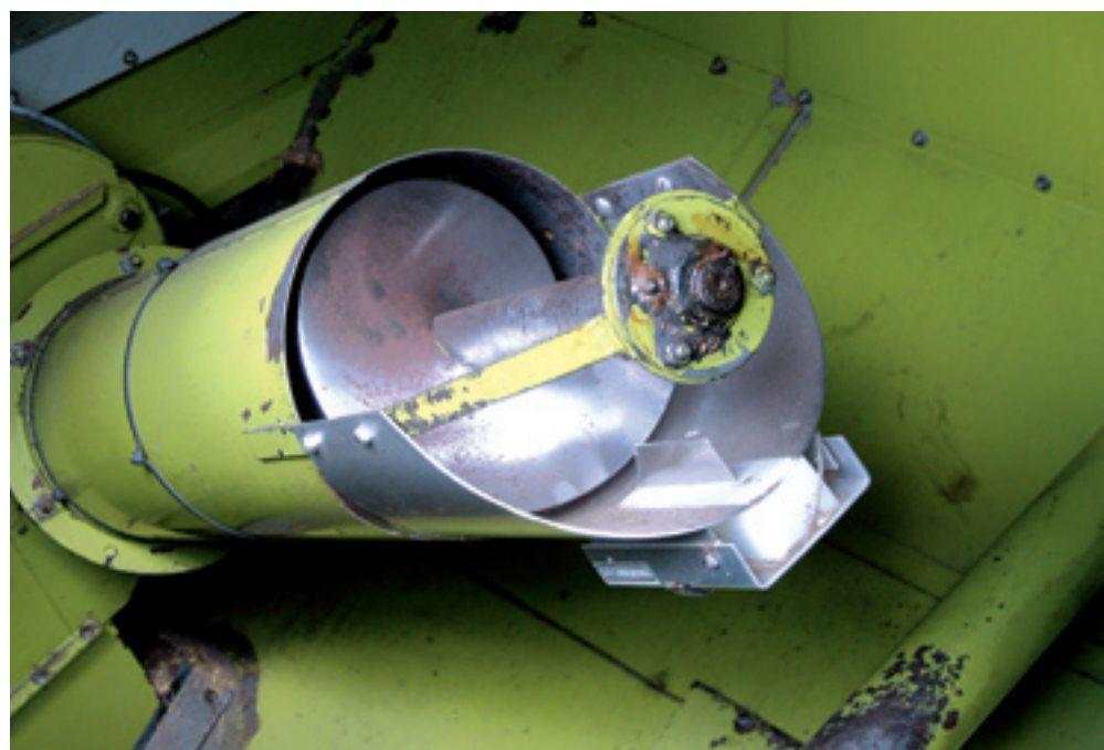
Met een sensor op het uiteinde van de graanvijzel in de tank wordt continu het elektrisch geleidingsvermogen gemeten als maat voor het vochtgehalte.
