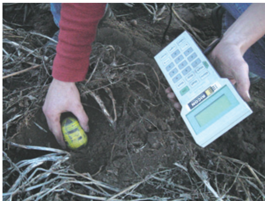
De elektronische aardappel wordt in de rug gestopt en doorloopt het hele proces die echte aardappelen ook afleggen.
