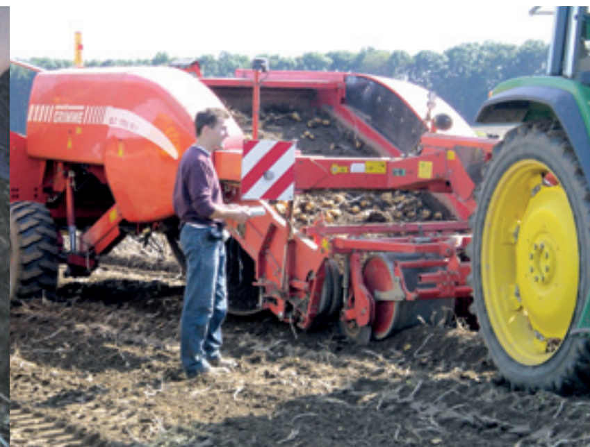
Naast aardappelrooier is het ook handig om de inschuurlijn door te meten met de rubberaardappel, zoals in de stortbak. Zo komen er nog wel eens knelpunten naar voren zoals de test in de grafiek laat zien.
