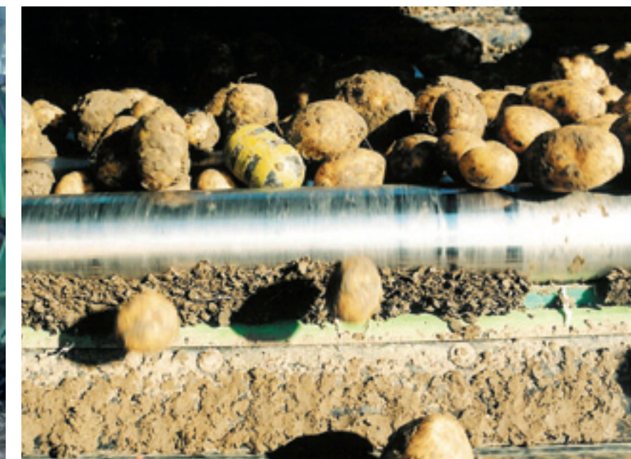
Naast aardappelrooier is het ook handig om de inschuurlijn door te meten met de rubberaardappel, zoals in de stortbak. Zo komen er nog wel eens knelpunten naar voren zoals de test in de grafiek laat zien.
