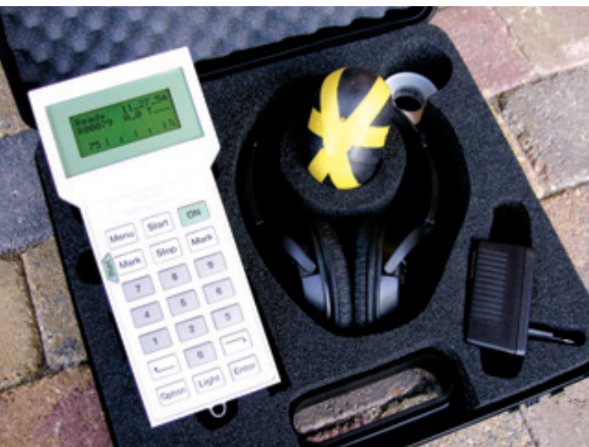
Apparatuur waarmee je de hele rooilijn, aardappelrooier en inschuurlijn, kunt doormeten op mogelijke beschadigingen van uw aardappelen.
