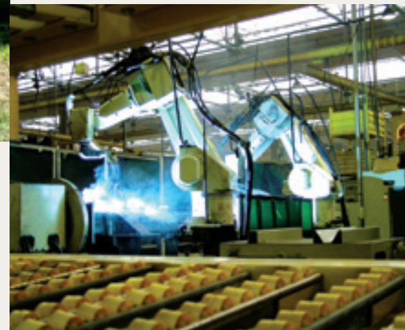
Een maaidorser in de Braziliaanse fabriek van John Deere wordt in 16 stappen gebouwd. Hier lassen twee lasrobots de vooras in elkaar.
