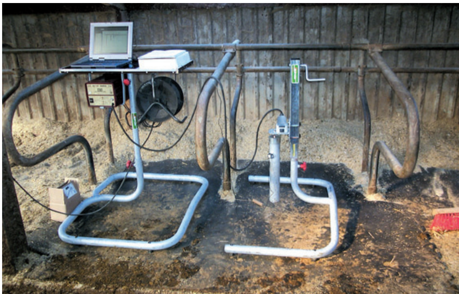
Onder praktijkomstandigheden is te meten hoe veerkrachtig een ligmatras is. Stalinrichter Spinder ontwikkelde er samen met twee studenten van het Van Hall Instituut een meetmethode voor.
