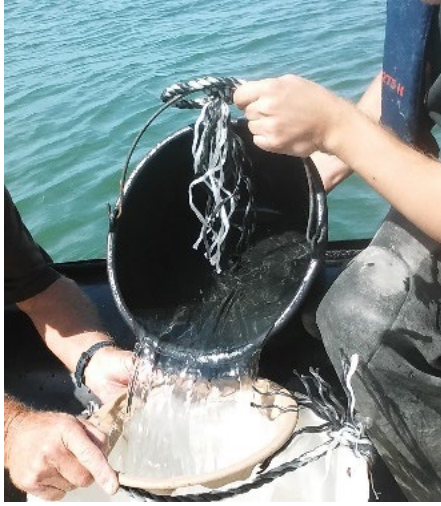
Figuur 2.8. Monsternet voor bepaling aanwezigheid oesterlarven.
