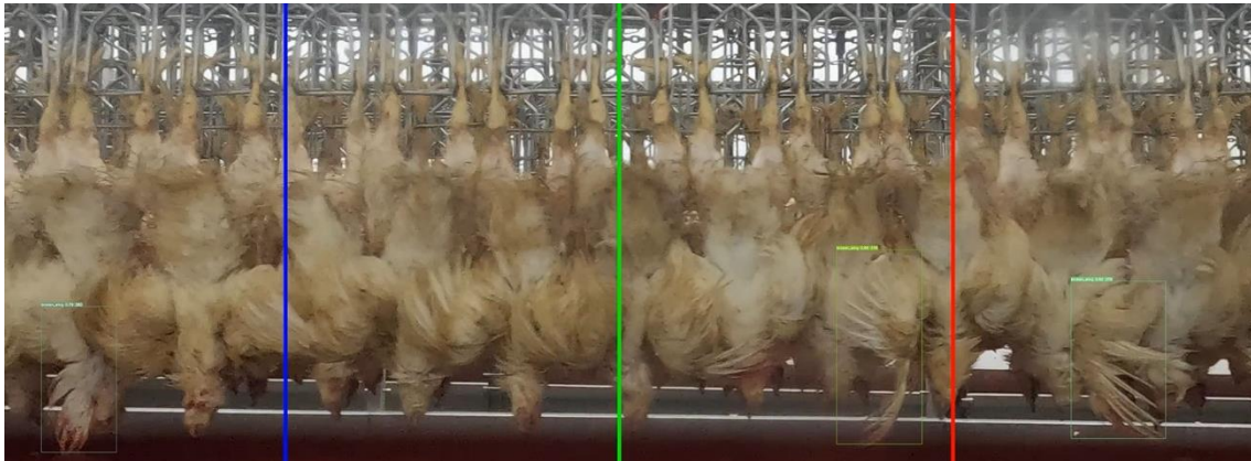
Figuur 7 Momentopname waarbij het algoritme een drietal afhangede vleugels detecteert.
