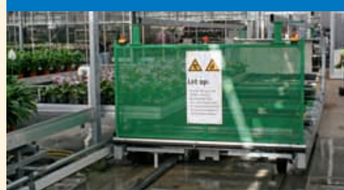
Met een middenwagen hoef je ‘slechts’ een halve kap te verzetten om een bepaald tablet te bereiken. Dat maakt een middenwagen aantrekkelijker dan een gevelwagen.
