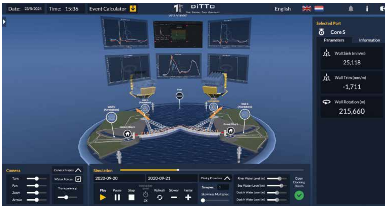
Afbeelding 1. User interface van het digital twin prototype, met in het midden een animatie van het sluiten van de kering (testsluiting 2020). Onderaan: bedieningspanelen voor simulaties. Boven: aanklikbare panelen voor aanvullende informatie zoals waterstanden, positie van de kering, pompgegevens enz. Rechts: 'live' waarden van de parameters inclusief de optie om meer informatie op te zoeken.
