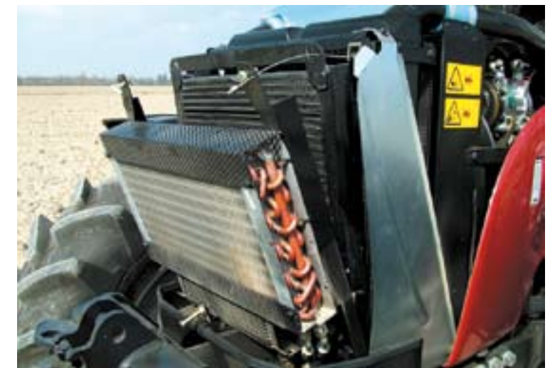
Het koelpakket is toegankelijk voor onderhoud als de motorkap omhoog is. Die motorkap gaat overigens ver genoeg open.
