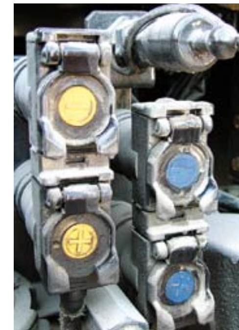
De hydrauliekaansluitingen achter op de trekker. Voorzien van een kleurcode, maar ook van een plus of min. Daardoor kom je niet meer voor verrassingen te staan.
