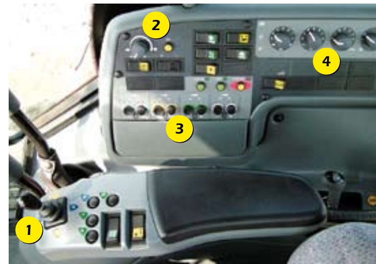
In de rechterarmleuning is een joystick (1) te vinden waarmee je twee hydraulische ventielen bedient. Op het console rechts naast de bestuurdersstoel zit het handgas (2), knopjes voor de bediening van de hydraulische ventielen (3), en de elektronische hef (4).
