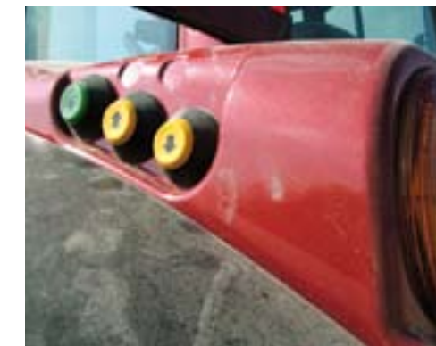
De aftakas en de hef zijn vanaf de spatborden te bedienen.
