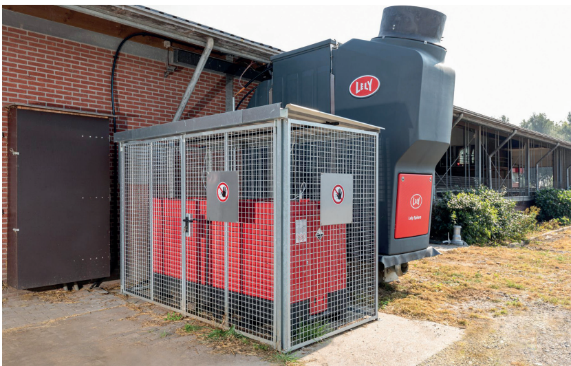
Met renure kan het spuiwater van de Lely Sphere, geproduceerd door de kelderafzuiger, ingezet worden als kunstmest
