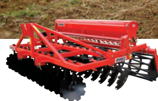
Een schijveneg zoals deze machine van Evers met nokkenradzaaimachine, snijdt de stoppels goed los en werkt groene doelen goed onder.
