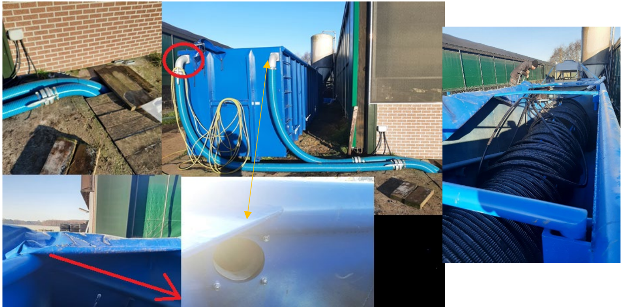
Figuur 16 Mest wordt met een pomp aangezogen vanuit de mestkelder (foto linksboven). De mest komt boven in de mestcontainer binnen (foto midden boven, rood omcirkeld), de leiding loopt binnen de container naar beneden door zodat de mest uiteindelijk onderin de mestcontainer wordt ingebracht (foto linksonder, rode pijl is richting van de mestleiding). Zodra het mestniveau in de mestcontainer hoog genoeg is loopt dit vanzelf terug via een andere leiding (gele pijl). Rechts, koelleidingen binnen de container.
