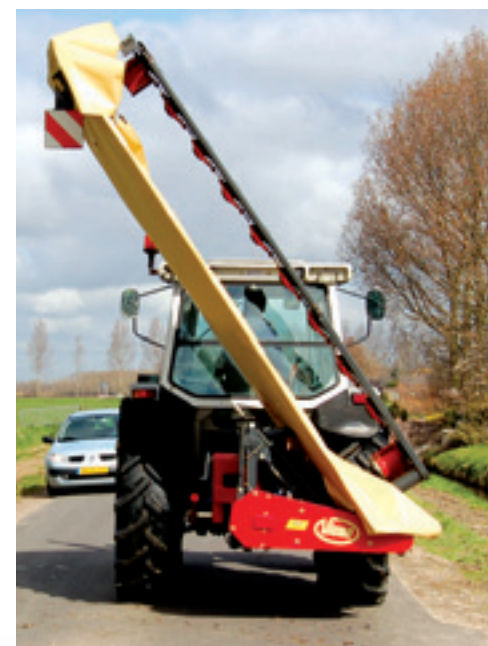
In transport is de maaier zeker vier meter hoog. Voor het parkeren in de berging kan een set verkregen worden om de maaier naar achteren te draaien.
