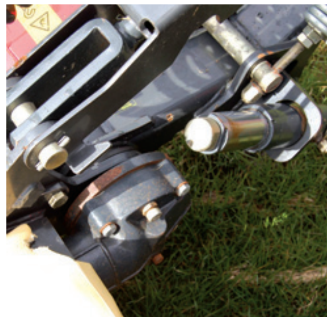
Bij het inklappen van de maaier beschadigt de kleine cilinder het doek.
