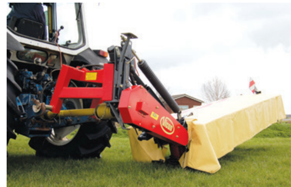
De maaibalk wordt via V-snaren aangedreven. Voor voldoende druk op de balk is er een grote veer.
