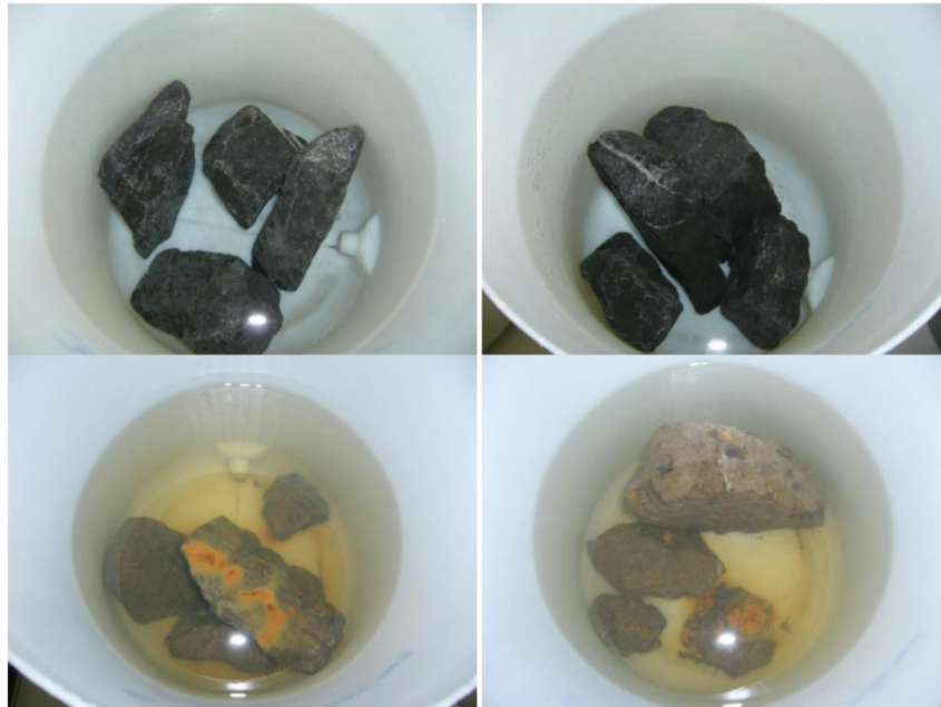
Figuur 2. Bovenaanzicht van breuksteen (boven) en staalslak (onder) na enkele dagen in zeewater. Breuksteen laat geen zichtbare interactie met zeewater zien, bij staalslak is duidelijk de beginnende roestvoering te zien (Foto's: L. Kästner in Dubbeldam, 2011).
