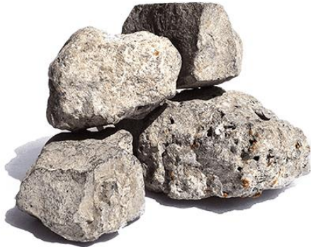
Figuur 1: LD-staalslakken geproduceerd volgens het Linz-Donawitz procedé (bron ROXX international).
