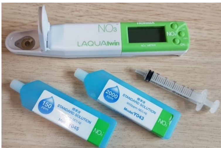
Figuur 4.1 De voor de praktijkevaluatie gebruikte LAQUAtwin nitraat-handmeter, inclusief gebruikte ijkvloeistoffen en spuitje voor monstername (aangeleverd in een doosje).
