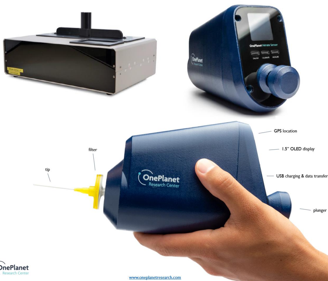
Figuur 3.1 Prototype breedbandige UV-VIS optische Nitraatsensor v1 (links) en eerste versie praktische draagbare optische nitraatmeter 'Niteryx' (rechts en onder).
