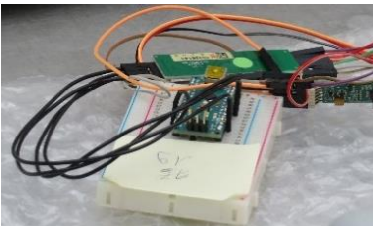
Figuur 2.3 Prototype ISE-nitraatmeter van imec/Holst Center.
