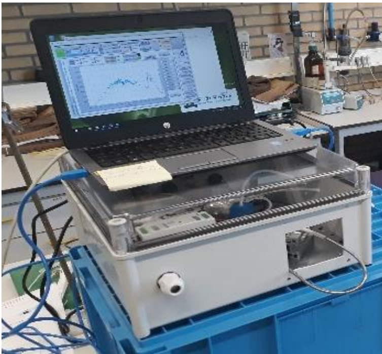
Figuur 2.4 Prototype nitraat monitoringssysteem gebaseerd op UV-VIS spectrometrie.
