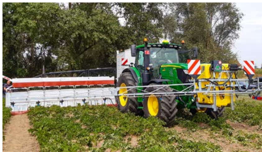
Toepassing van elektrische loofdoding met een systeem ontwikkeld door Nucrop op een demodag in 2022.
