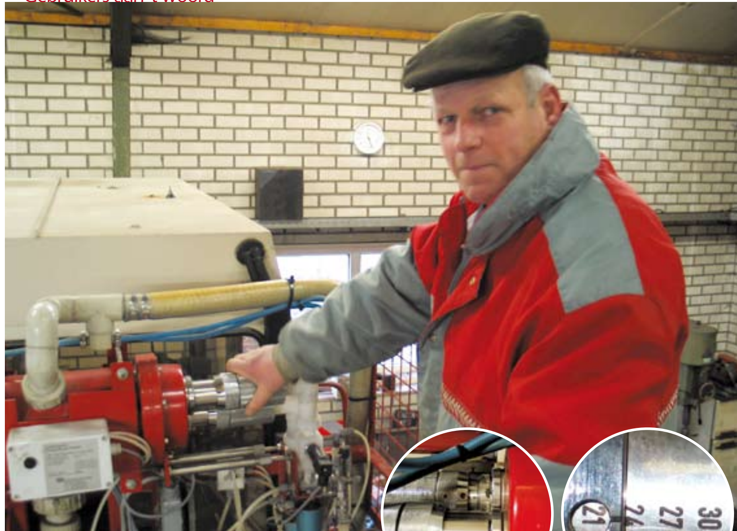
De heer Hoenink uit Enschede laat zien hoe de concentratie van het spuitmiddel is in te stellen bij de injectiespuit. Het oog in de draaiknop geeft de concentratie aan, hier in promillen.
