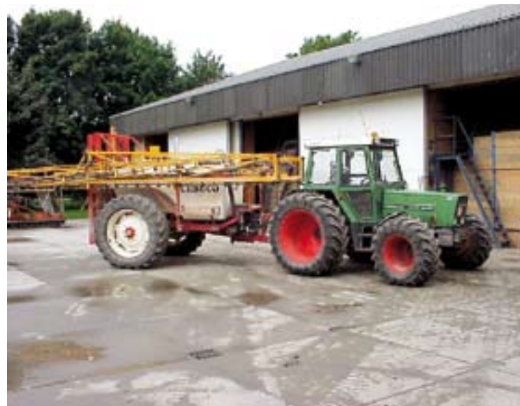
Getrokken spuit op breed spoor voor rijpaden met fuseebesturing op brede banden.
