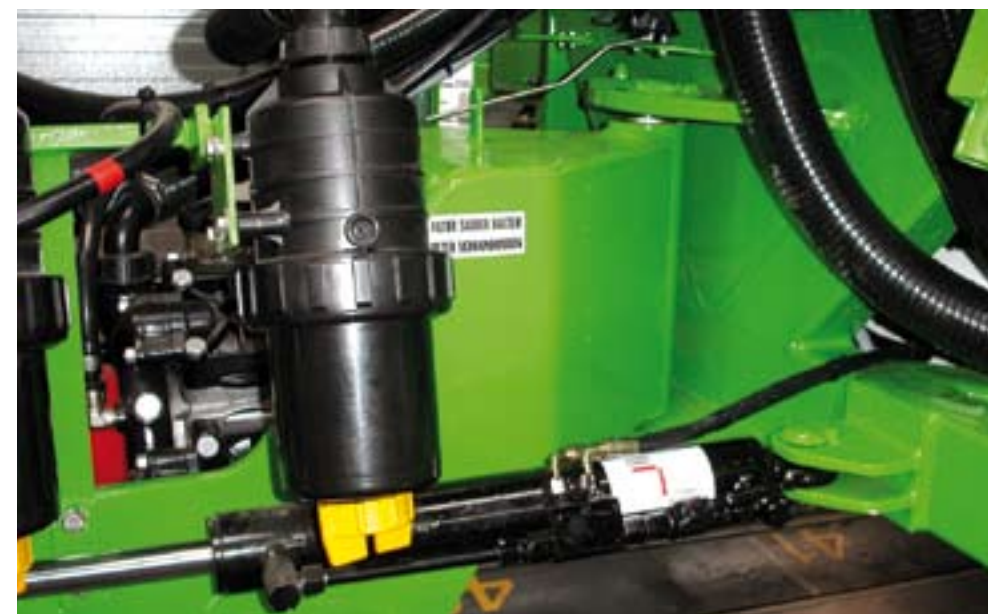
Detail van disselbesturing met afsluitkraan op de hydraulische cilinder en automatische middenpuntinstelling.
