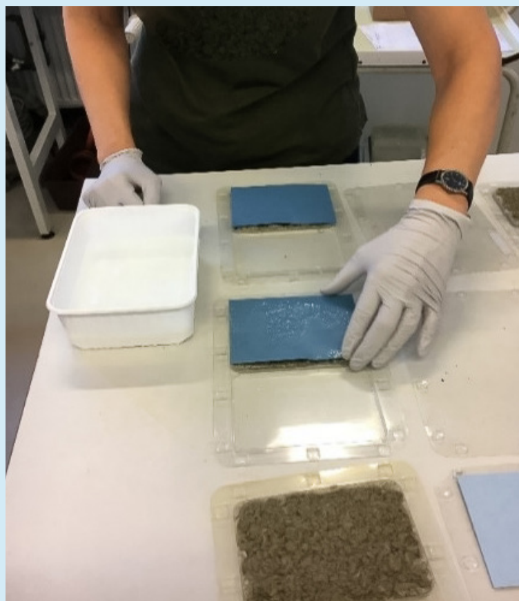
Figuur 1: Voorbereiding en uitslag van de groei van tuinkers in een testkit met controle (A) en een chloordioxide behandeling (B). Hier geeft de chloordioxide behandeling een negatief effect op de groei van de tuinkers.
