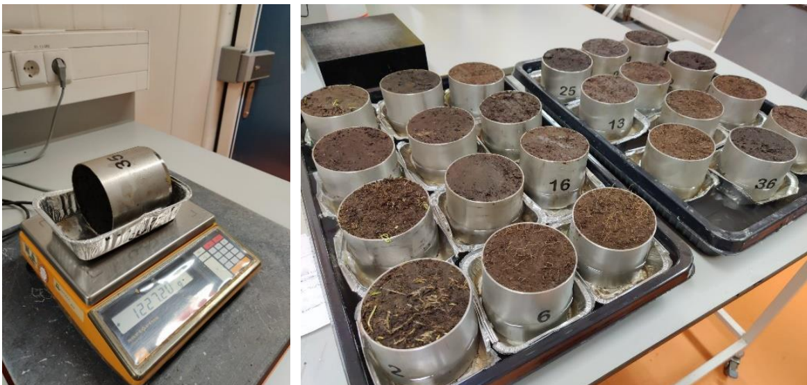
Figuur 11 Wegen ringen (links) en verzadigen monsters (rechts) in het lab. De foto rechts wijkt af van de beschrijving in de tekst door de dunnere waterlaag, maar illustreert wel de methode (foto's: P. Gerritsen).
