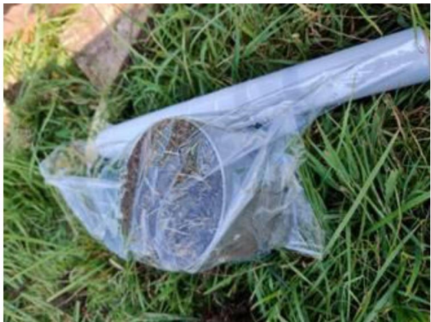
Figuur 7 Bewerking van het monster (links) en het inpakken van het monster met folie voor vervoer (rechts) (foto's: P. Gerritsen).
