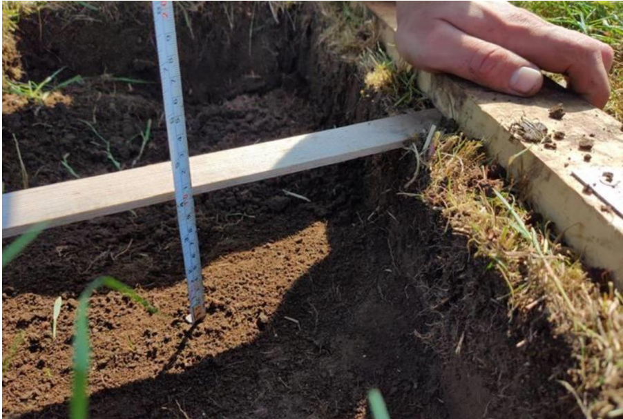
Figuur 8 Referentiehoogte bepalen (foto: P. Gerritsen).
