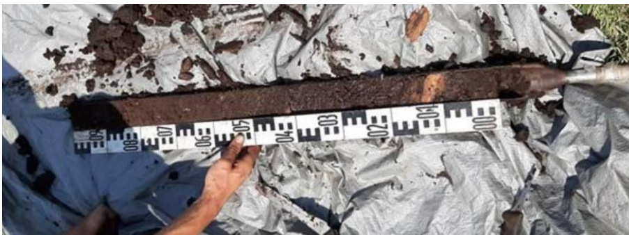
Figuur 3 Bemonstering met guts (foto: H. Massop).
