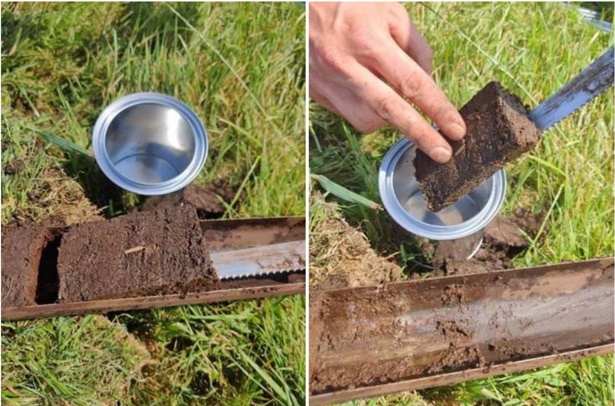
Figuur 10 Uitsnijden 10 cm interval (links) en monster in verfblik plaatsen (rechts) (foto's: P. Gerritsen).
