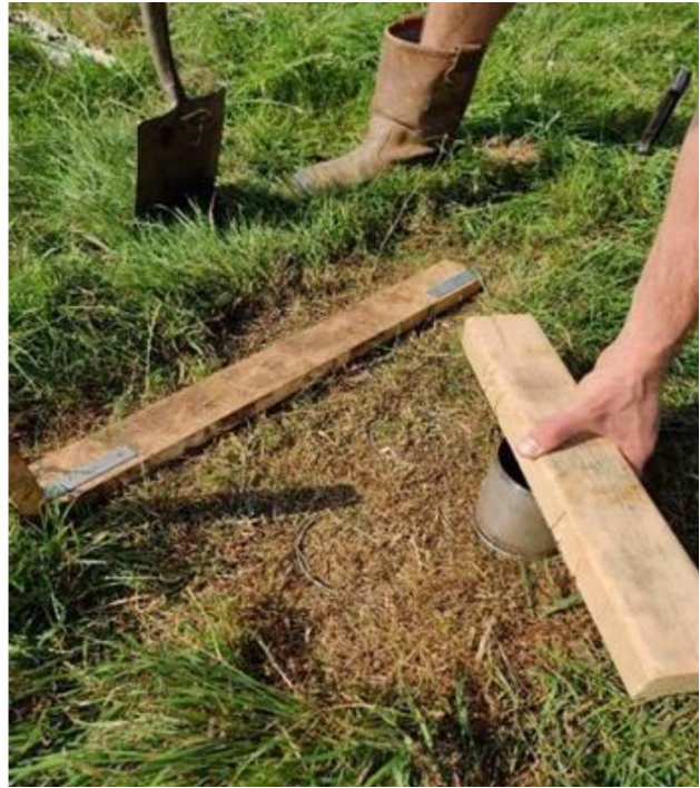
Figuur 6 Eerste drie ringen voor interval 0 – 10 cm (links) en inslaan van de ringen (rechts) (foto's: P. Gerritsen).
