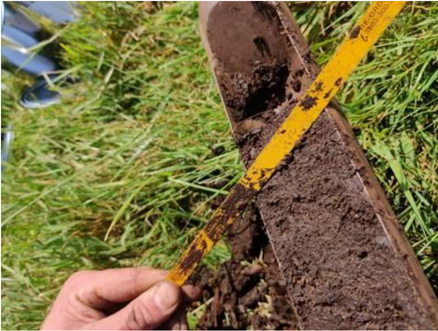
Figuur 9 Horizontaal afvlakken van de guts (foto: P. Gerritsen).
