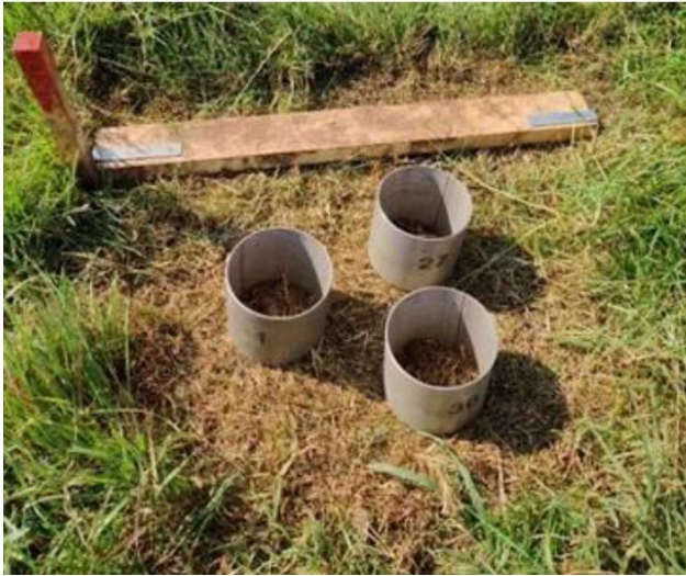
Figuur 6 Eerste drie ringen voor interval 0 – 10 cm (links) en inslaan van de ringen (rechts) (foto's: P. Gerritsen).
