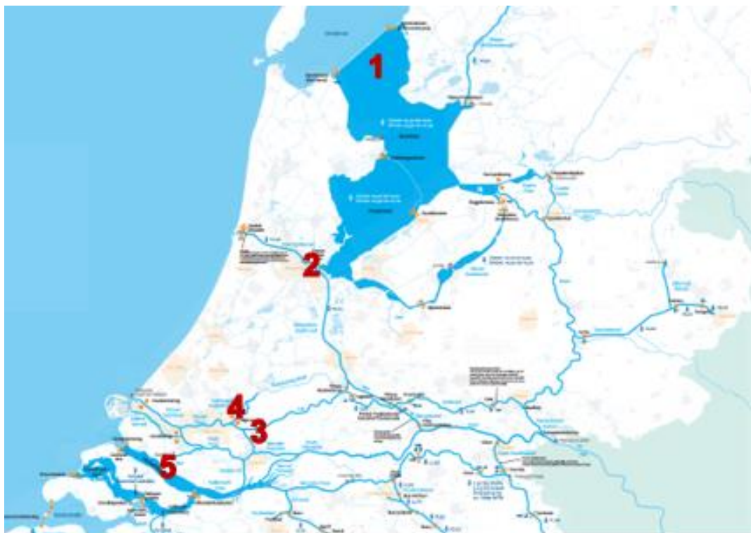
Figuur 2.8 Overzicht hoofdwatersysteem Nederland (uitsnede uit kaart van Rijkswaterstaat van Helpdesk Water) met de belangrijkste locaties waar externe verzilting kan optreden: 1. Schut- en spuilsuizen IJsselmeer; 2. Sluis IJmuiden; 3. Monding Lek bij Kinderdijk; 4. Monding Hollandse IJssel (Krimpen aan de IJssel); 5. Innamepunt bij Bernisse (in combinatie met Spijkenisse).
