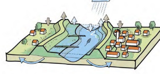
TOEKOMST ZONDER AANPASSING? hoogwaters frequenter en hoger, toenemende kwetsbaarheid (meer bebou- wing) op dalend land, hogere dijken, geen ruimte dijkverlegging
