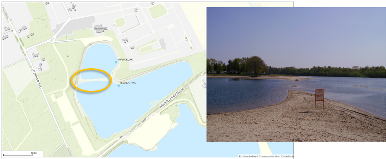
Fig. 12: Verlaagde zanddijk waardoor water met hoge pH uit grote zwemplas naar kleine zwemplas stroomde
