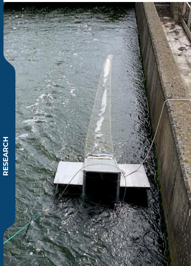
Figuur 20 Met behulp van een Manta Trawl worden monsters genomen van het effluent van de waterzuivering.
