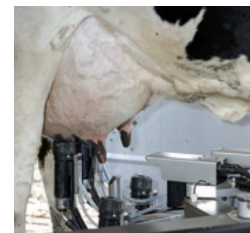
De Titan robot van RMS heeft een referentiespeen nodig om aan te sluiten en maakt onderandere gebruik van geluidsgolven.
