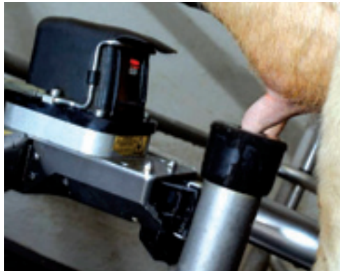
De VMS van DeLaval sluit het melkstel aan met behulp van twee lasers en een camera. De ene laser zorgt voor de grove richting en de andere laser is er voor de precisie.
