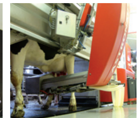
De Lely heeft geen mechanische koevolgter. De arm ziet via de weegvloer waar het zwaartepunt van de koe is en volgt dat.
