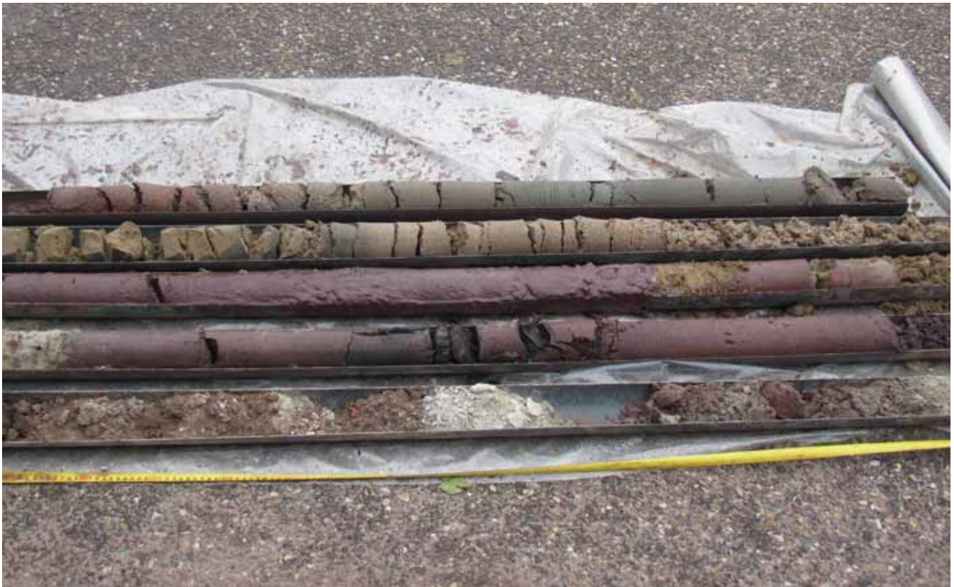
FOTO 2: SCHIJNGRONDWATERSPIEGEL, CONTAMINATIE VAN DIEPER GELEGEN ZANDLAGEN.
