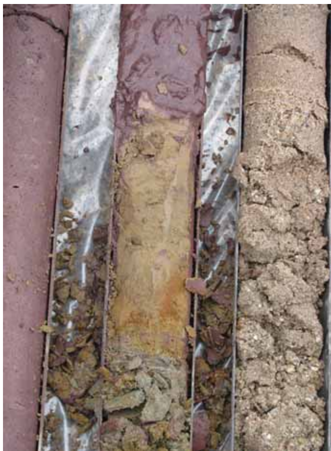
FOTO 1: WATERVERZADIGDE PYRIET-AS RUST OP GECEMENTEERDE LAAG EN KLEILAAGJE MET DAARONDER DROOG ZAND.
