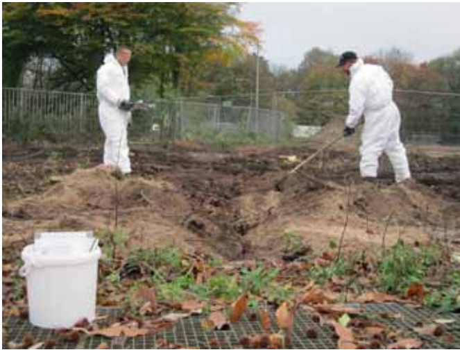
AFBEELDING 2: MAAIVELDINSPECTIE BIJ NADER ASBESTONDERZOEK (FOTO: H. BRUINS, I.T.WORKS).
