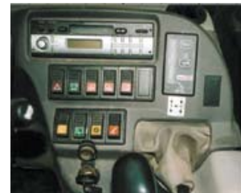
Rechts van het stuur zit het overzichtelijke bedieningspaneel met rechtsboven een krachtmeter.
