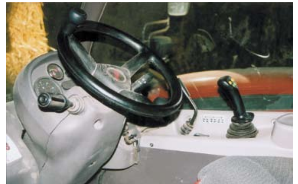
Met de joystick in de cabine bedien je de verschillende hydraulische functies van de giek. Met de optionele Load Sensing Ultra (LSU) in het hydraulisch systeem van de Manitou verreiker kun je meerdere hydraulische functies tegelijk uitvoeren onafhankelijk van de belasting.
