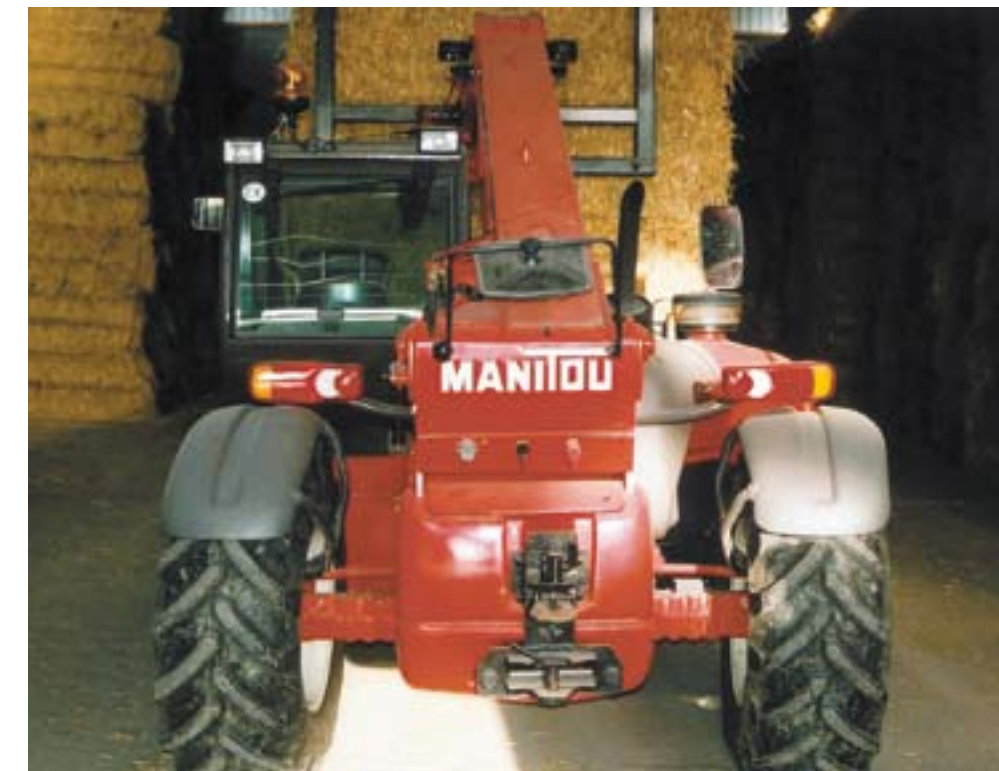
De MLT 633 van achteren bekeken: 2,3 m breed en hoog. Het zicht vanuit de cabine naar achter is verbeterd dankzij plaatsing van de motor aan de rechterzijde van de cabine.
