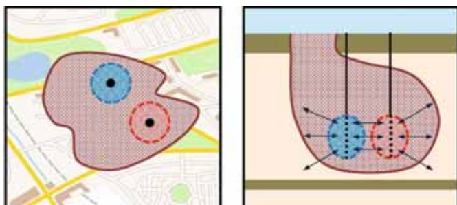
FIGUUR 2: SCHEMATISCHE WEERGAVE VAN EEN WKO-SYSTEEM MET DE BRONFILTERS IN EEN GRONDWATERVERONTREINIGING.
