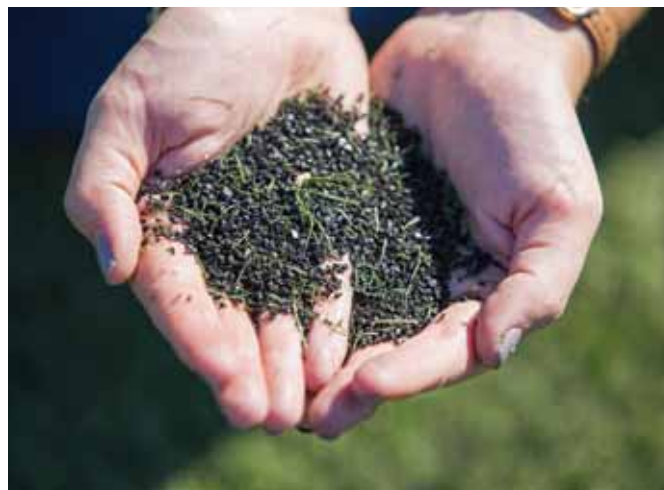
FIGUUR 3. RUBBERKORRELS OP VOETBALVELDEN: GEMALEN AUTOBANDEN MET VEEL CONTAMINANTEN.
