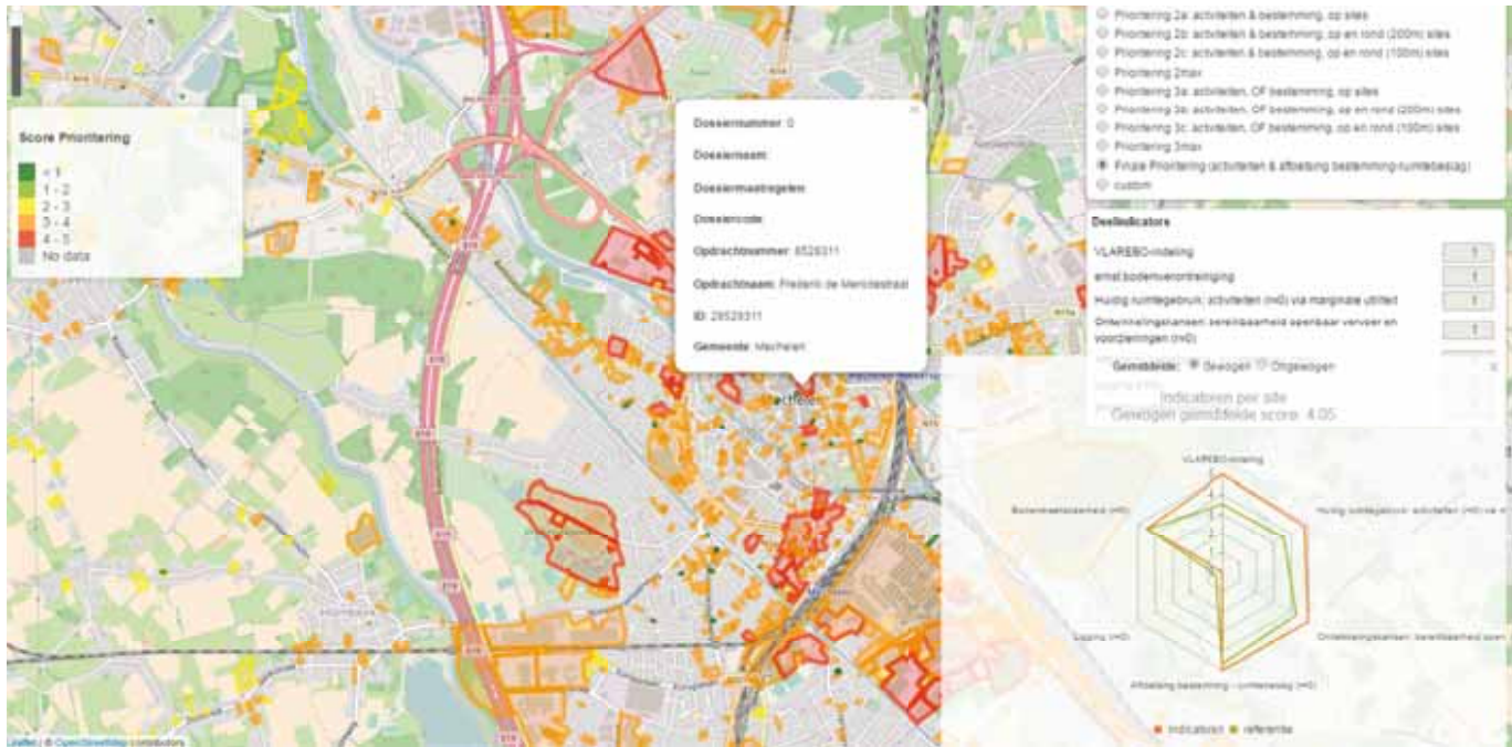
FIGUUR 3: SCREENSHOT VAN HET MODEL VOOR DE TESTGEMEENTE MECHELEN (BRON VITO) : PER LOCATIE WORDEN DE INDICATOREN VOORGESTELD IN EEN 'SPIDER-TOOL'. IN DE FIGUUR KRIJGT DE LOCATIE EEN SCORE 4,05 OP EEN TOTAALSCORE VAN 5 EN HEEFT DAARMEE EEN HOGE PRIORITEIT.
