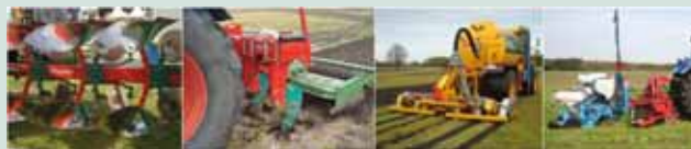
Foto 1: Werktuigen voor grondbewerking. Van links naar rechts: ploeg, NKG vol-veld, Strokenfrees, beperkt woelen + zaaien. Foto's J. Deru, LBI.
