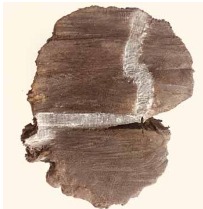
FOTO 3: MET EEN SCHEERMESJE EN KRIJGT ZIJN ALLE JAARRINGEN VAN DE BIJ WAGENINGEN GEVONDEN VEENEIKEN ZICHTBAAR GEMAAKT.
