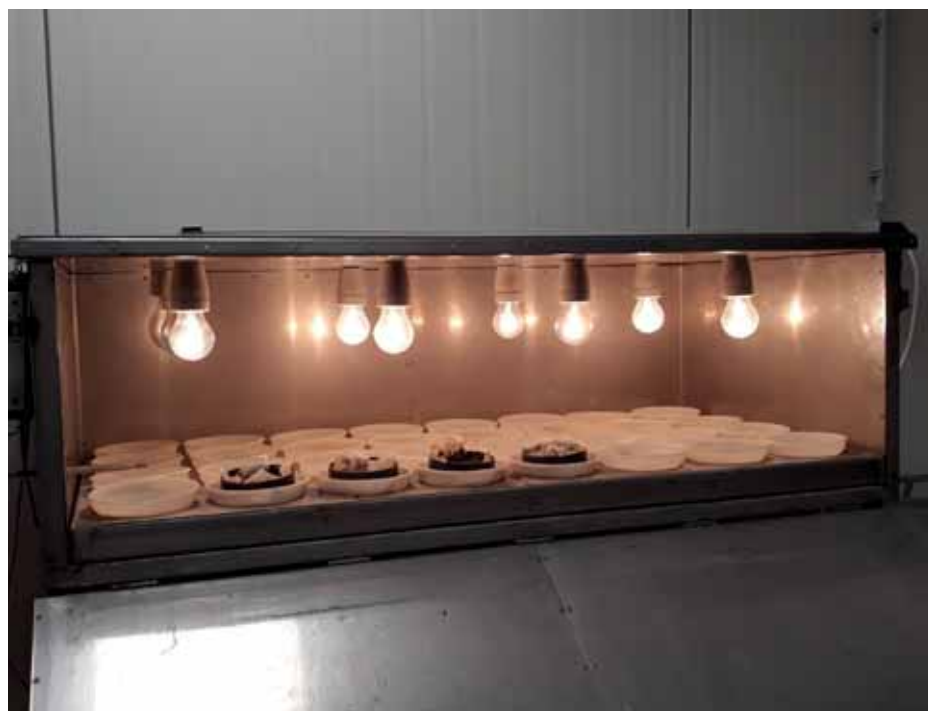
FOTO 2: EXTRACTIEOPSTELLING OM POTWORMEN TE VERZAMELEN. DE LAMPEN VERWARMEN DE GRONDMONSTERS IN DE TRECHTERS. POTWORMEN VLUCHTEN NAAR BENEDEN, WAAR ZE IN EEN BUISJE WATER VALLen. (FOTO DOOR T. SALÁNKI).
