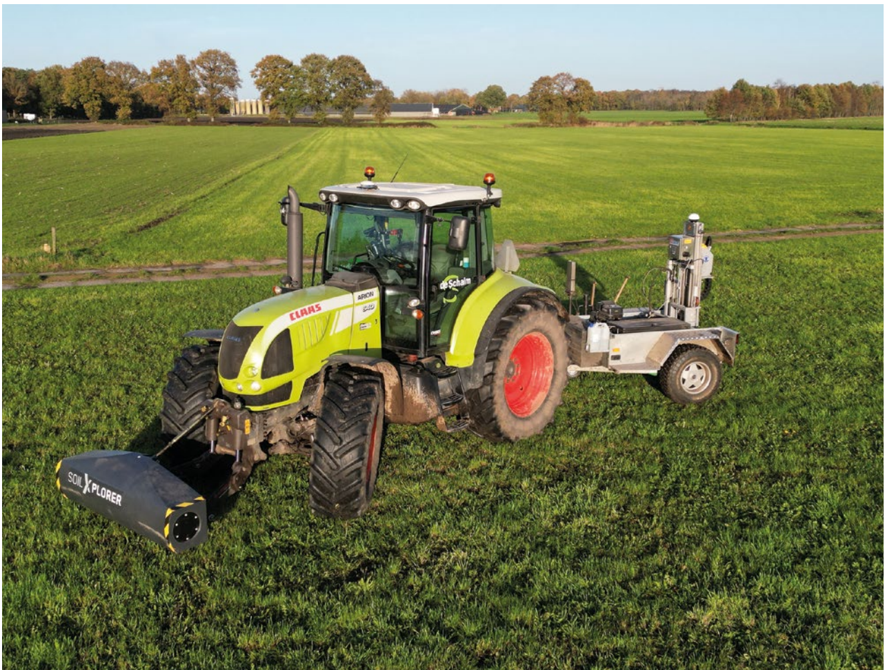
De bodemscanner voorop de tractor en erachter hangt een monsteremer.
