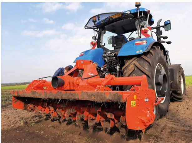
Met een biomulcher worden verse gewasresten met de toplaag van de bodem vermengd
