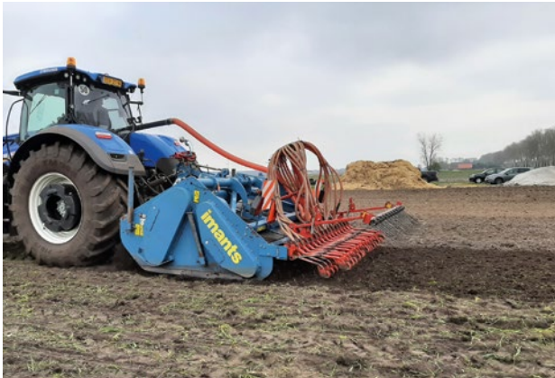
Met een spitmachine worden gewasresten ondergewerkt in de toplaag van de bodem en een zaaibed gemaakt.
