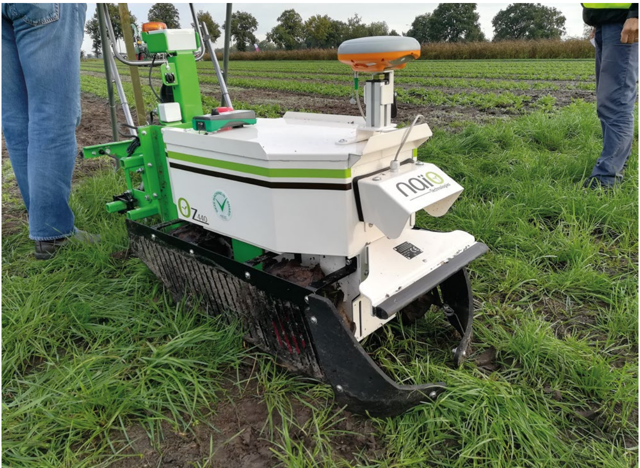
De Naïo Oz, een autonome robot die naast mechanische onkruidbestrijding ingezet kan worden voor verschillende toepassingen.
