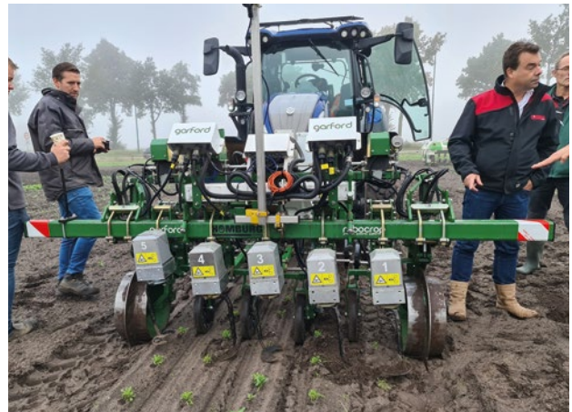
Robocrop InRow van Garford, die schoffelen tussen en in de rij mogelijk maakt door geavanceerde camerabesturing.
