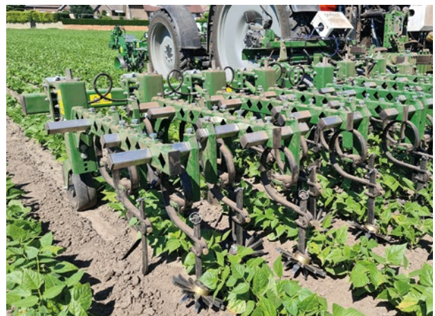
Robocrop InterRow van Garford van 9 meter breed die met camerabesturing heel nauwkeurig tussen de gewasrij schoffelt.
