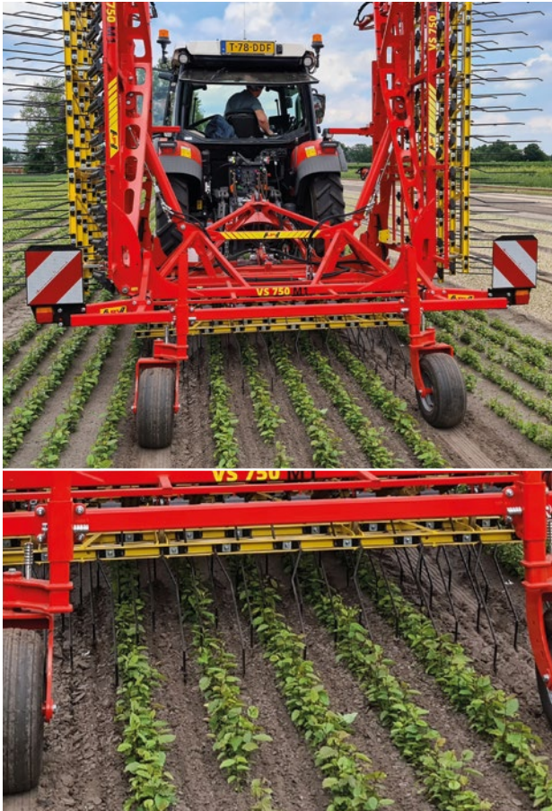
Verstelbare wiedeg van APV en ingezoomd op het eggen tussen de gewasrij.
