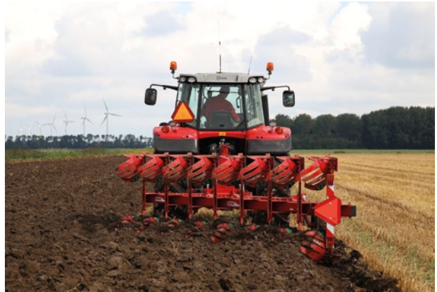
Met een ecoploeg wordt slechts 8 tot 10 cm diep geploegd.
