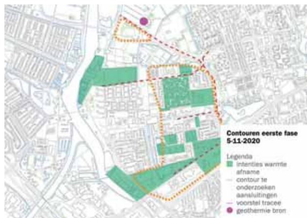
FIGUUR 3: CONTOUREN EERSTE FASE VAN HET WARMTENET EN DE GEOTHERMIEBRON IN ZWOLLE (BRON: CORRESPONDENTIE ERIC HUYGEN, GEMEENTE ZWOLLE).
