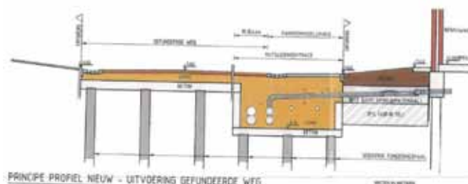
FIGUUR 1. SCHEMA VAN OPBOUW VERHOOGDE WEG, NUTSLEIDINGENTRACÉ EN OPGEHOOGDE TUINEN
