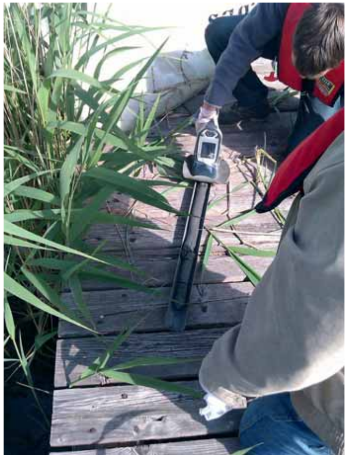
FIGUUR 2: HET METEN VAN EEN SLIBMONSTERS MET DE XRF.
