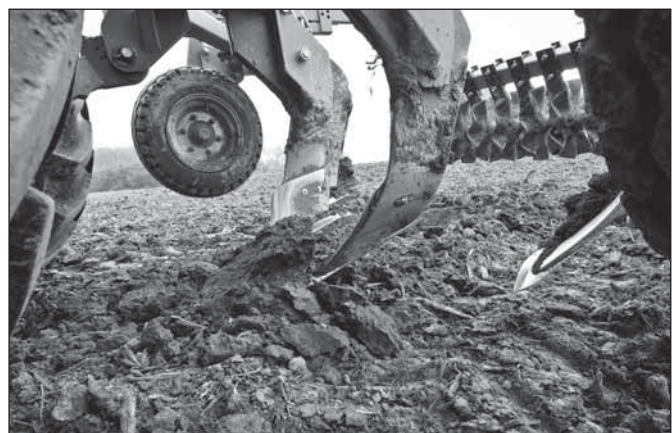
FOTO 1. BODEMBEWERKINGSINSTRUMENT (OF WOELER) DIE DE GROND MET BEITELS OPTILT, VERBREEKT EN DOORLUCHT OP EEN DIEPTE VAN 20-25 CM.
