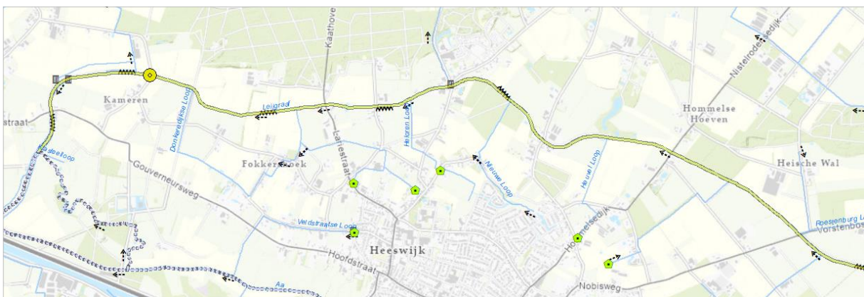
Figuur B6.4: Leijgraaf benedenstrooms met overstorten (groene stipjes) en mate van normoverschrijding (gele bol)
