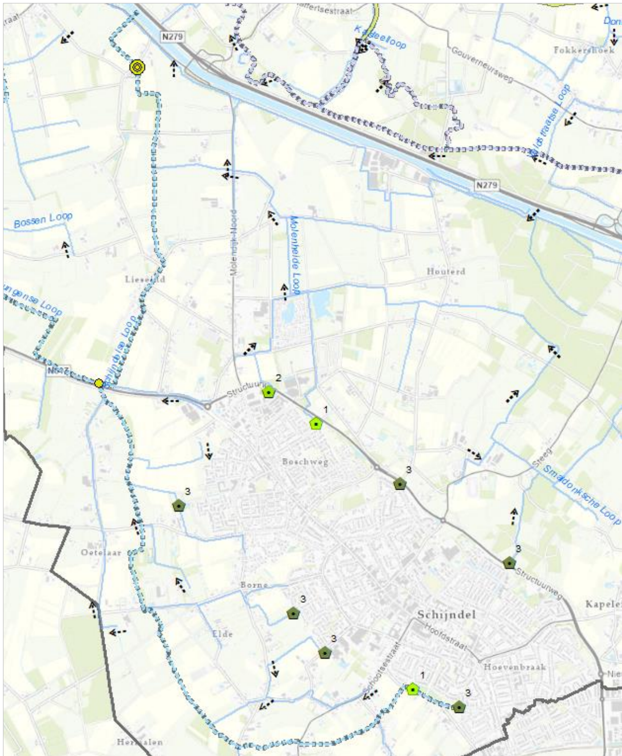
Figuur B6.4: Schijndelse Loop met wegingsfactor overstorten (groene stipjes) en mate van normoverschrijding (gele bollen)
